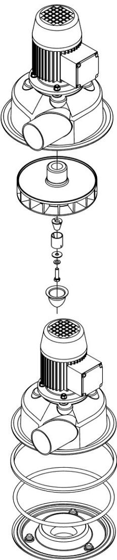
2. Laufrad aufsetzen, positionieren und festziehen
