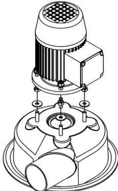
1. Motor an Gehäuse-Oberteil verschrauben
