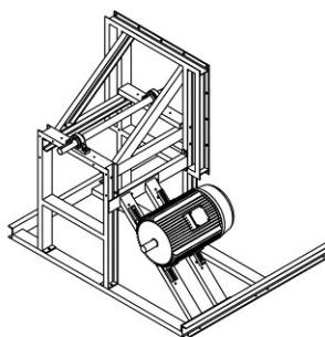
1. Einzelteile des Ventilatorständers miteinander verschrauben. Lagereinheiten und Welle auf den Ständer montieren. Motor auf Ständer befestigen.
