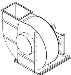
4. Stützwinkel an Grundrahmen schrauben.
