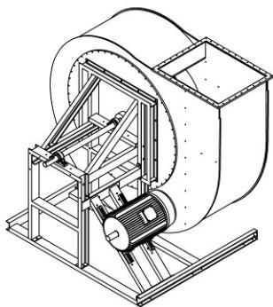
3. Gehäuse mit Rondelle verschrauben.
