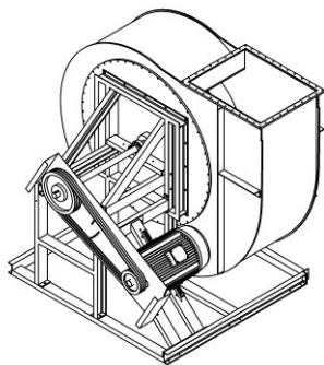
5. Riemenschutzblech und Keilriemenantrieb montieren.
