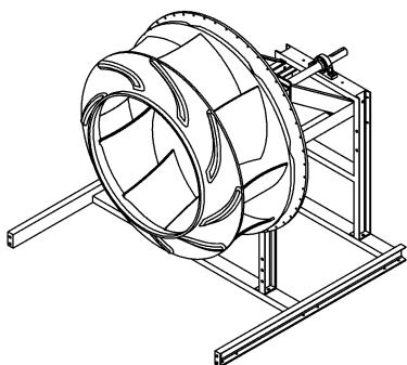
2. Rückwand an Ständer montieren. Laufrad auf Antriebswelle schieben.
