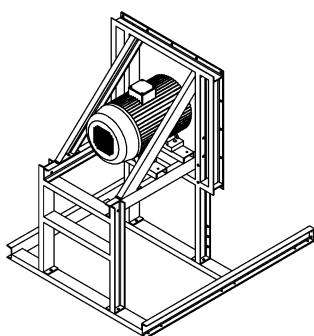
1. Einzelteile des Ventilatorständers miteinander verschrauben. Motor auf Ständer montieren.
