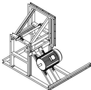
1. Einzelteile des Ventilatorständers miteinander verschrauben. Lagereinheiten und Welle auf den Ständer montieren. Motor auf Ständer befestigen.
