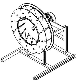
2. Rückwand am Ständer montieren. Laufrad auf Welle schieben.
