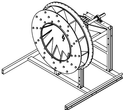
2. Rückwand und Ständer montieren. Laufrad auf Antriebswelle schieben.
