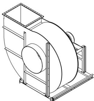
4. Stützwinkel an Grundrahmen schrauben. Gehäuse-Abstützung vorne und hinten montieren. Laufrad positionieren, festziehen und Nabendekung montieren.
