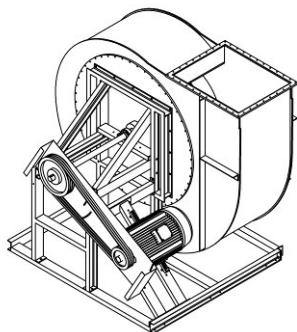
5. Riemenschutzblech und Keilriemenantrieb montieren.
